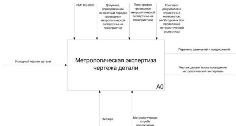
Рисунок 1. Информационная модели процесса «Метрологическая экспертиза чертежа детали».
