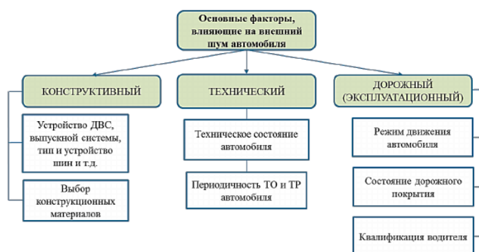
Рисунок 1. Факторы влияющие на шум автомобилей.
