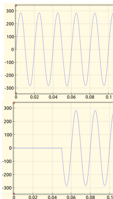
Рисунок 4. Временные диаграммы напряжения сети при работающей нагрузке после подключения сетевого силового фильтра (точки Pr1, Pr2).
