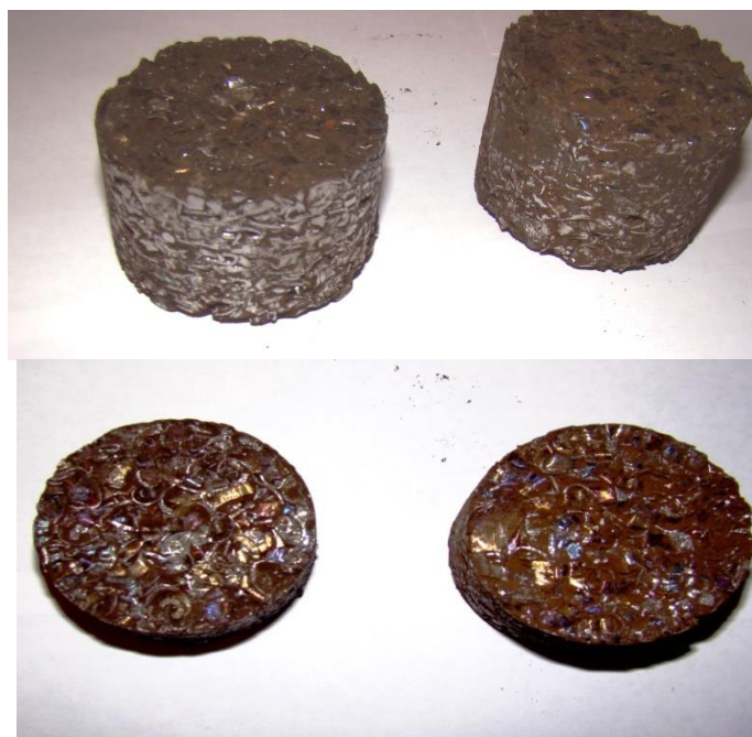
Рисунок 2. Брикеты из стали ШХ 15 со связующими компонентами.
