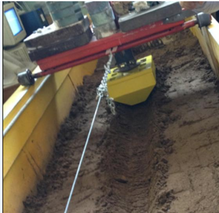
Рисунок 1. Определение тяговых усилий при работе модели ковша каналоочистителя.
