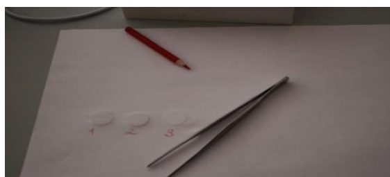
Рисунок 2. Подготовка образцов воды к сканирующей зондовой микроскопии.
