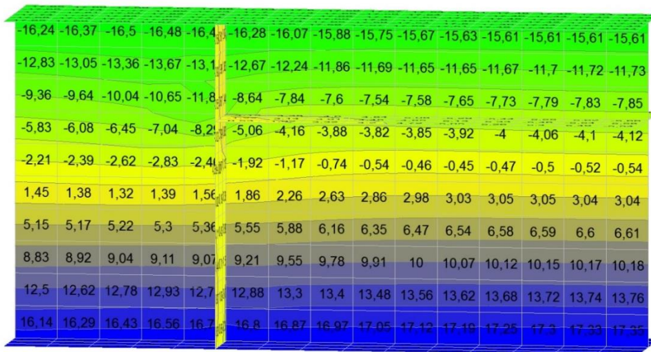
Рис. 6. Мозаика нормальных напряжений \sigma , \text{kH}/\text{cm}^2 , модель с продольным ребром
